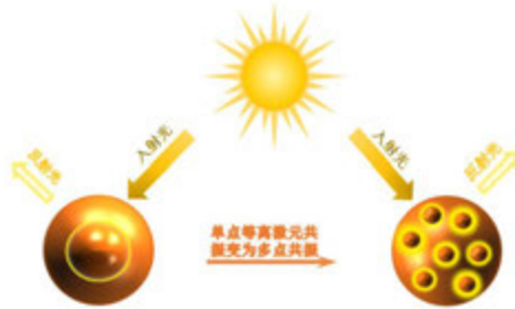
图1 球壳结构和多点式结构的等离子体共振点示意图
